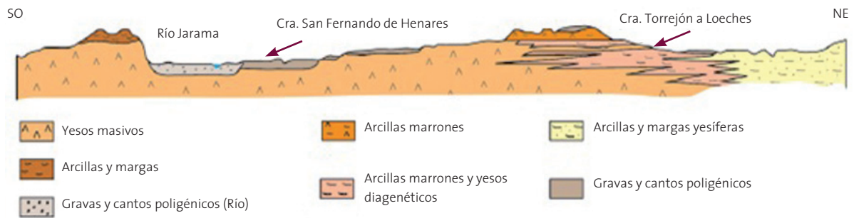
Figura 6. Corte geológico al norte de la zona de estudio (Modificado por Camiña-2015 de la hoja 560 serie MAGNA)
