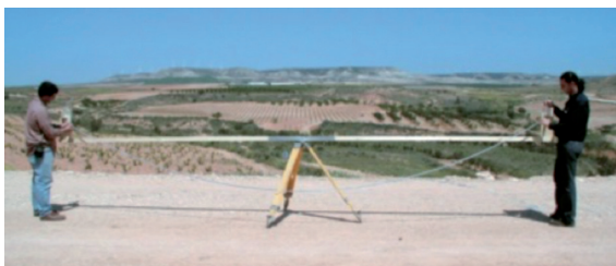
Figura 6. Comparación de nivelaciones de Corobate y nivel actual, Moreno Gallo, 2004
